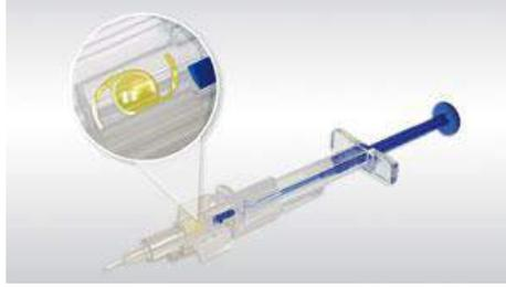
微創之白內障手術，係經由微小切口推注人工水晶體於眼內，植入匣之表面若無潤滑處理，則將因摩擦發生推注困難及人工水晶體磨損破裂。目前主要有二種植入系統潤滑方法，一是將具有潤滑性之 GMS (Glyceryl Monostearat, GMS，單硬脂酸甘油酯)加入 PP(Polypropylene, PP，聚丙烯)原料中混練(Compounding)，再以此混練後材料製作植入匣。二是在 PP 植入匣管壁表面塗佈潤滑材料。植入匣之表面潤滑處理為人工水晶體植入系統製造之必要程序，其市場需求將隨植入系統於白內障手術市場普及而成長。
