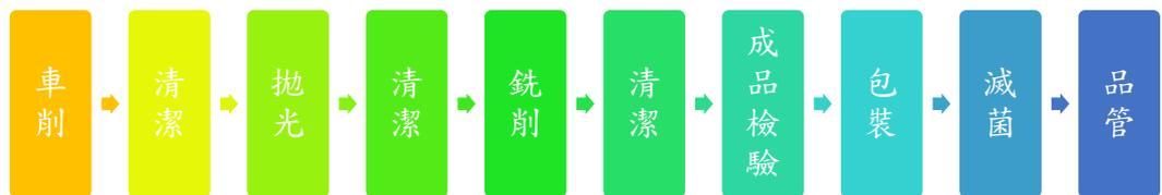
人工水晶體植入系統生產製程如下：
